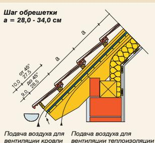
Подача воздуха для вентиляции кровли
