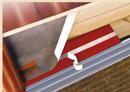
Карнизный лист металла укладывается под гидроизоляционную пленку на всю обрешетку у карниза, и он выступает под карниз.
