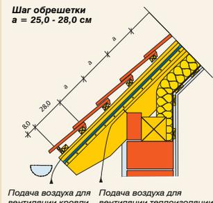
Подача воздуха для вентиляции кровли      Подача воздуха для вентиляции теплоизоляции
