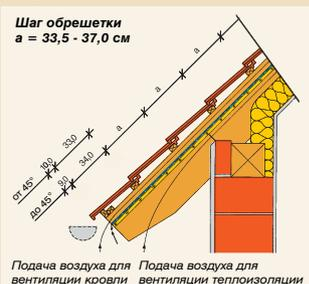
Подача воздуха для вентиляции кровли
