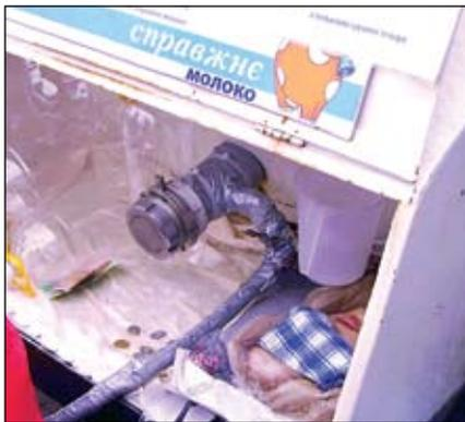
Чтобы исключить возможность поражения человека электрическим током, принято решение использовать напряжение питания 12 В. Для подключения к сети 220 В были применены тороидальные понижающие трансформаторы. В качестве нагревательных элементов использовались силиконовые нагревательные кабели. Мощность обогрева рассчитывалась с учетом невозможности нормально теплоизолировать гибкие шланги.
