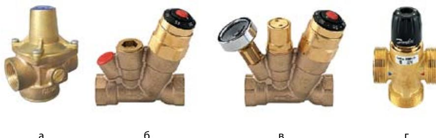
**Рис. 1.** Автоматические регулирующие клапаны современных систем горячего водоснабжения: а – редуцирующий клапан 7BIS; б – термостатический циркуляционный клапан MTCV версия «А»; в – многофункциональный термостатический циркуляционный клапан MTCV версия «В»; г – термостатический смесительный клапан TVM-W
