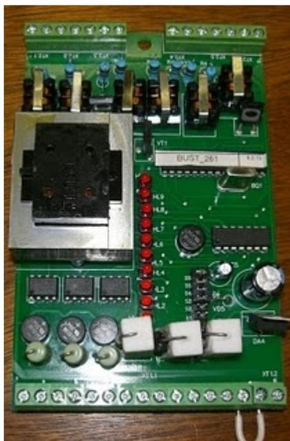
При первом включении прибор заработал сразу. К сожалению один из 8 купленных блоков работал неправильно - при нулевом токовом сигнале, выдавал порядка 10-15% мощности в нагрузку.
