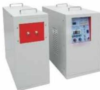
Как правило, они имеют выходной диапазон частот 0,5-20 кГц. Столь низкая частота определяет область их применения. Это в основном плавка черных и цветных металлов, глубокий нагрев для горячей штамповки, закалка металлов на максимально возможную глубину. Например, закалка крановых колес. Данные индукционные установки имеют максимально возможную глубину горячего проникновения индукционного поля, до 10мм от поверхности металла.
