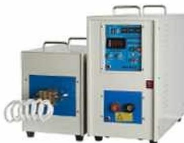
Как правило, имеют выходной диапазон частот 20-40 или 30-100кГц. На выходе такой индукционной установки всегда имеется понижающий высокочастотный трансформатор, который следует нагружать на индукционную катушку с количеством витков от 1 до 4. Диаметр индукционной катушки растет с увеличением мощности ТВЧ генератора.
