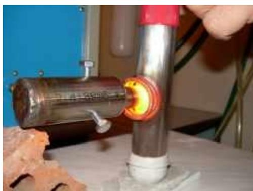
Изготовление простого индуктора совсем не сложно. Набейте отожженную круглую медную трубку просеянным песком или мелкой солью, сплющите ее края и смело навивайте индукционную катушку необходимой вам формы и количества витков. После навивки необходимо отрезать края трубки, тщательно вытрясти содержимое и промыть трубку водой. Иногда индукционную катушку навивают через прокладку на самую нагреваемую
