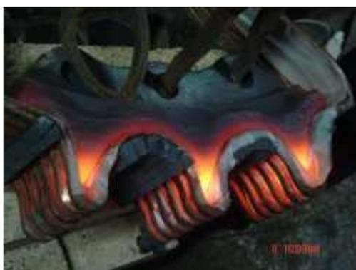
Все эти материалы обладают громадной магнитной проницаемостью и насыщаемостью. Их применение позволяет повысить коэффициент передачи электромагнитной энергии от индукционной катушки в нагреваемый металл на десятки процентов. Однако при работе сам концентратор сильно нагревается. Поэтому, как правило, «П» образный концентратор с целью эффективного отвода тепла, закрепляют на прямоугольной медной трубке с помощью теплопроводной мастики.
