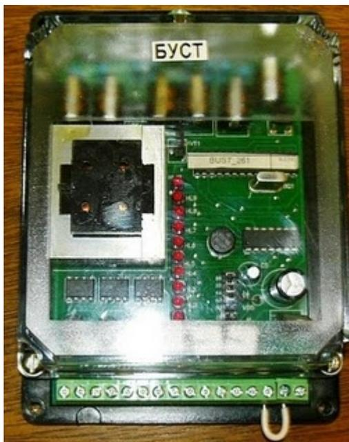
Работа прибора управляется микроконтроллером. Он выполняет синхронизацию с сетью и определение угла отпирания для трех групп полупроводниковых вентилей. Для индикации уровня мощности используется линейка из 10 светодиодов. Здесь кроется первый недостаток - невозможно определить состояние прибора, так как при включенном питании и отсутствии сигнала ни один светодиод не горит.
