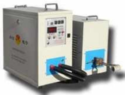
Они имеют выходной диапазон частот от 100кГц до 1,5МГц. Глубина горячего проникновения индукционного поля составляет около 1мм. Исходя из этого их основное назначение поверхностная закалка стальных деталей и нагрев тонких проволок и пластин.
