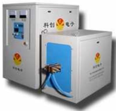
Габариты и вес индукционного оборудования созданного по новейшим технологиям на транзисторных JGBT модулях и MOSFIT транзисторах во много раз меньше такого же по мощности оборудования на лампах. Это позволяет размещать его на малых площадях и в непосредственной близости с оборудованием последующего производственного цикла.
