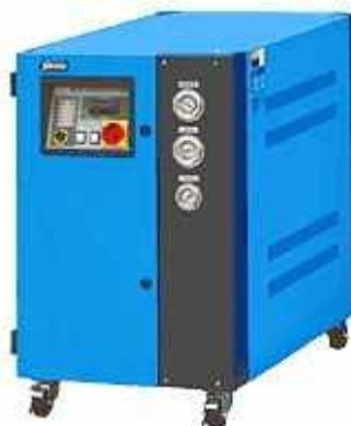
Чиллером называется автоматический фреоновый холодильник для воды. Чиллер типа Вода-Воздух сбрасывает тепло в воздух цеха или на улицу. Чиллер типа Вода-Вода отдает тепло проточной воде. Фреоновый насос позволяет удалять тепло с большой эффективностью за счет высокой разницы температур в средах. А так же поддерживает температуру охлаждающей жидкости в заданных пределах при любой температуре проточной воды и воздуха на улице или в цеху.
