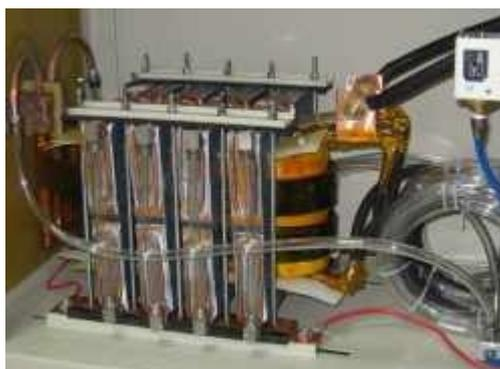
Более мощные модели всегда имеют вынесенный в отдельный блок высокочастотный водоохлаждаемый трансформатор. В таком трансформаторе охлаждается водой многовитковая первичная и многорядная вторичная обмотки, а так же охлаждается ферритовый сердечник, как снаружи, так и изнутри. На таком трансформаторе, как и в ТВЧ генераторе, обязательно стоит отдельный сильфонный датчик давления воды, срабатывание, которого приводит к выключению всей установки.
