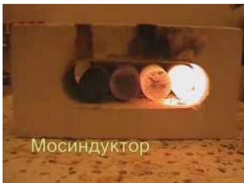
В случае применения кондукторов (это зажимные устройства для нагреваемых деталей) и при сканирующей закалке, индукционную катушку оставляют без изоляции. А вот если деталь подается в зону нагрева вручную и есть возможность касания индуктора, индукционную катушку следует футеровать жаропрочным материалом желательнее с малой
