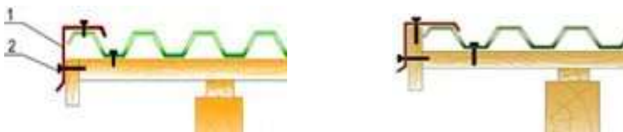
Рис. 7 Крепление ветровой планки
